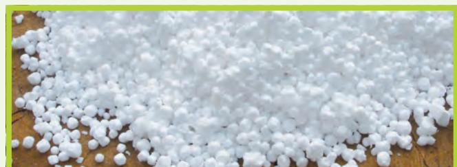
Polystyrenová ekologická tepelná izolace BALIZOL je vyráběna recyklací polystyrenu. Čisté polystyrenové kuličky se zafoukávají na požadovaná místa obytných domů, průmyslových i zemědělských staveb s důrazem na prostory se zvýšenou vlhkostí nebo kondenzací vodních par.
